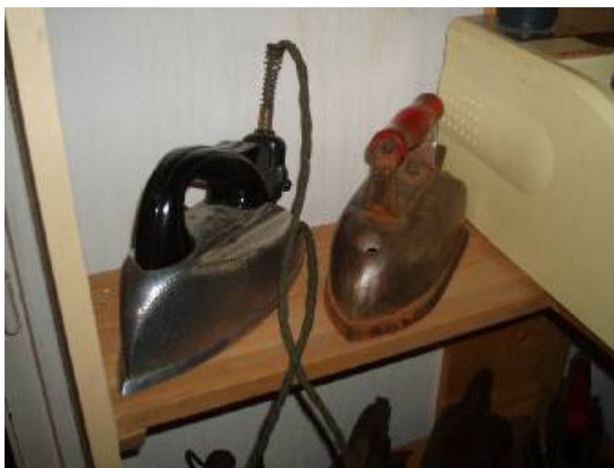
Amerikkalainen malli liitettiin sähköjohdolla hehkulampun paikalle esim. kattova- laisimeen.
